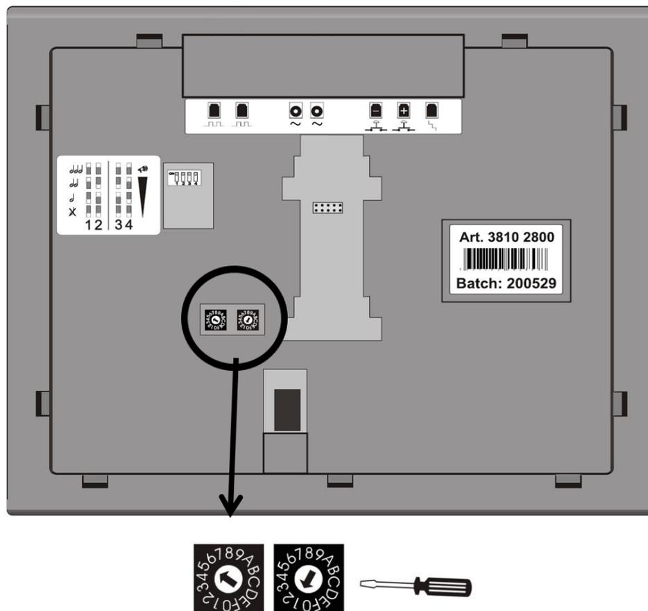
Auf der Rückseite des Displays sind zwei Nummernkreise. Die Pfeile innerhalb der Nummernkreise können mit einem kleinen Schraubenzieher gedreht werden.
