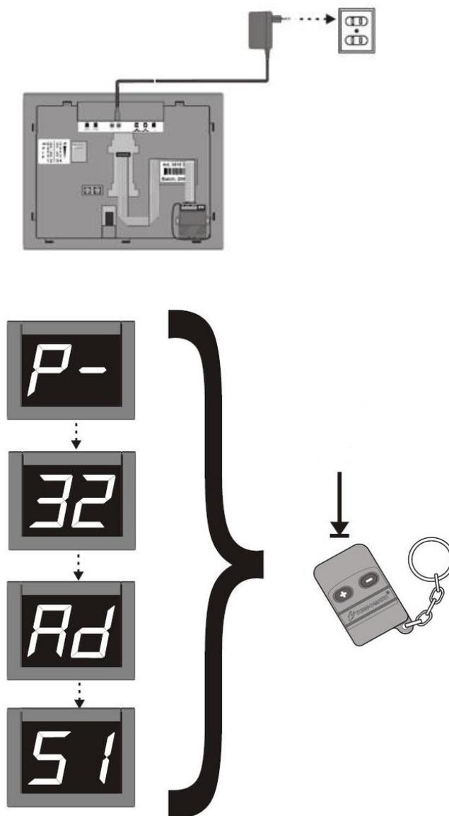
Um Einstellungen am Display vorzunehmen, muss mindestens ein kabelloser Umschalter mit dem Display mit einem Receiver verbunden sein.
