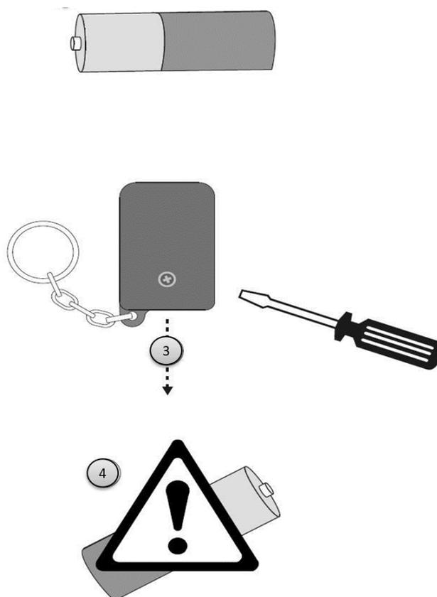
Die einzusetzende Batterie ist die Alkaline MN21 12V.
